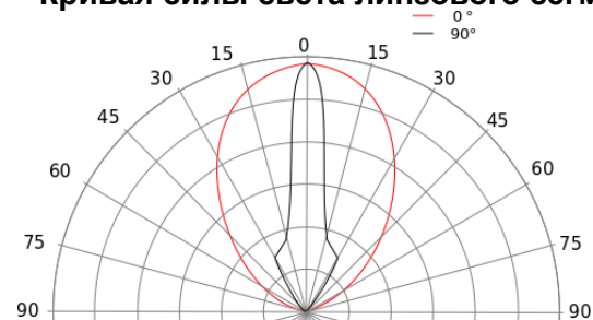
Кривая силы света рабочего сегмента светильника
