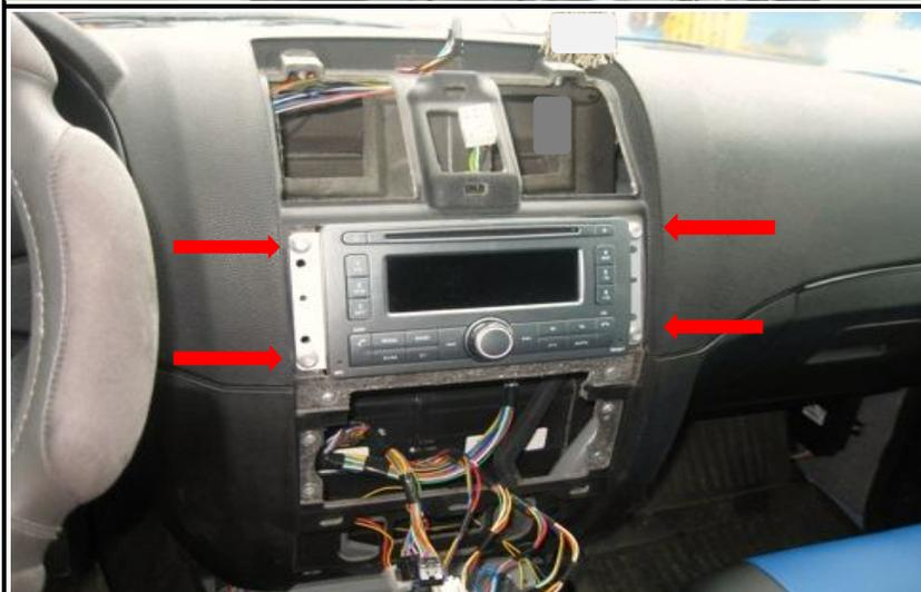
5) Отвернуть 4 болта крепления и снять магнитолу в сборе, отсоединив колодки жгута проводов.
