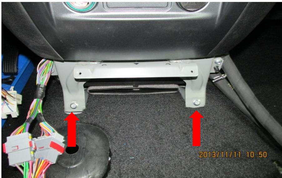
13) Отвернуть два нижних болта крепления панели приборов.
