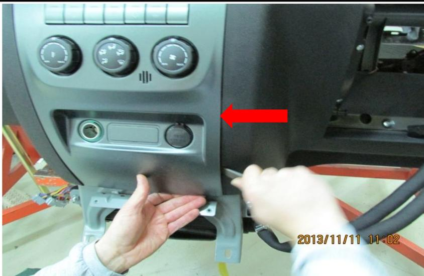
2) Снять нижнюю центральную консоль. Используя шпатель аккуратно потянуть снизу. (Крепиться на 5 фиксаторах).
