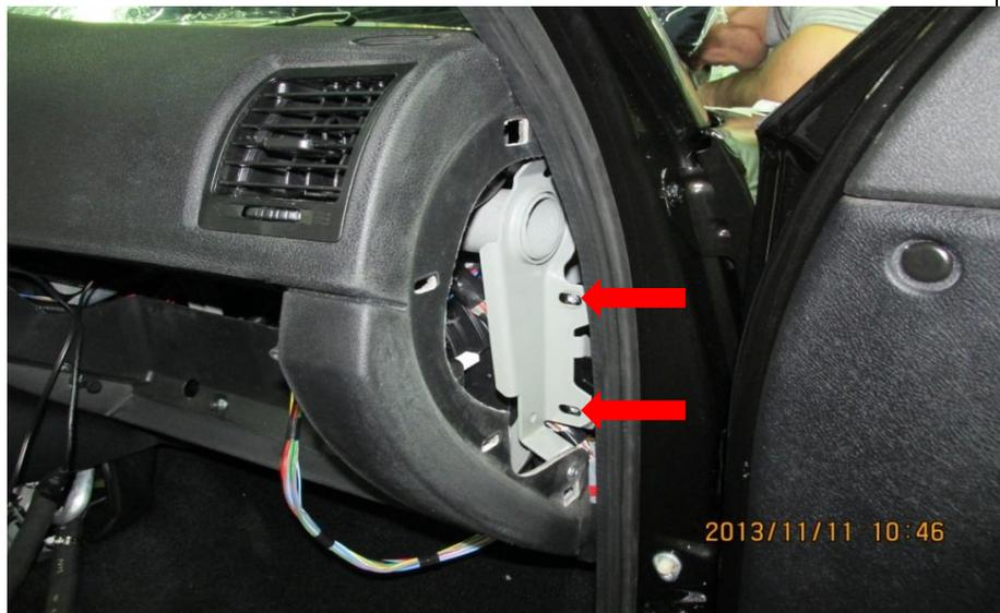
13) Отвернуть по два боковых (справа и слева) болта крепления панели приборов и снять панель приборов с автомобиля.
