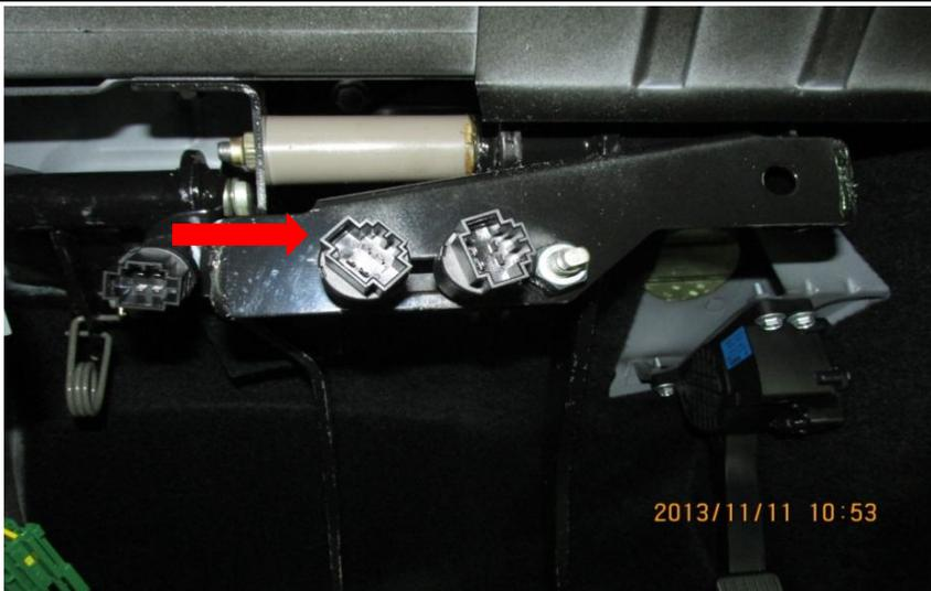
9) Вручную отсоединить колодки жгута проводов основного провода от разъёмов датчиков на блоке педалей.
