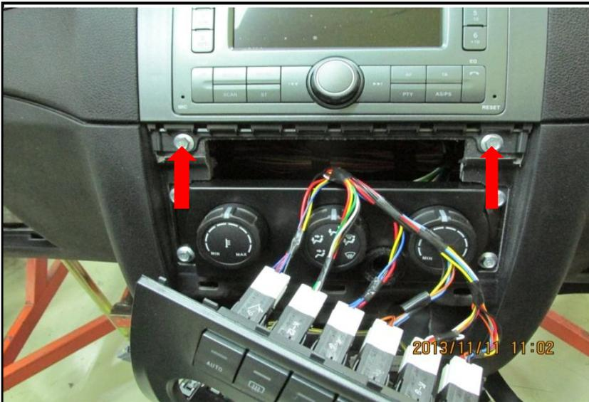
4) Отвернуть 2 нижних болта крепления верхней центральной консоли и снять её.
