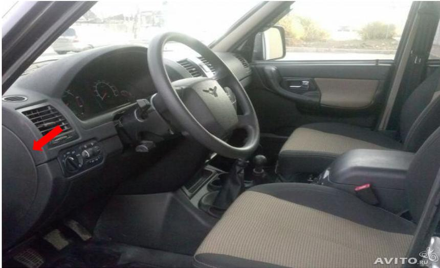
**5) Снять боковые накладки панели приборов:**
