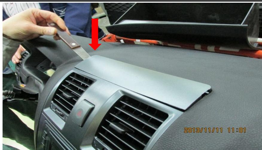
1) Снять верхнюю накладку верхней центральной консоли Аккуратно, используя шпатель, поддеваем верхнюю накладку и снимаем её. (Крепится на двух фиксаторах).
