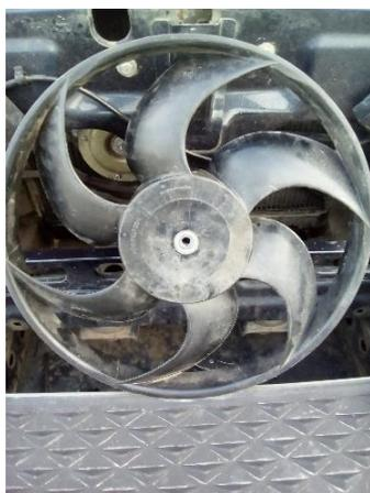
Нивы. Диаметр 340 мм, в отличие от штатного, диаметр которой 290 мм. Здесь же приведена фотография обратной стороны. Я сточил выступающие ребра жесткости, чтобы они не задевали за болты крышки самого вентилятора, если заменить болты на потайные, то может и не надо будет стачивать, или стачивать
