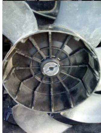
меньше. Далее, если крыльчатка предназначена для вращения по часовой стрелке (как эта), нужно поменять местами провода в разъёме вентилятора «+» и «-», чтобы направление вращения двигателя вентилятора совпадало с направлением вращения крыльчатки.
