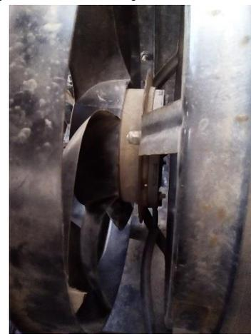
Гайка для крепления крыльчатки. Усики обламываются, и оставшиеся оплывы становятся стопорами при затягивании гайки, за счет взаимодействия с центральной металлической частью крыльчатки.
