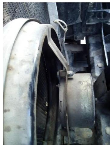
Как видно вентилятор развернут на 180 градусов, на вал посажены две дистанционные шайбы, чтобы вентилятор не задевал за болты крепления, упомянутые ранее, его диффузор крепится с помощью дополнительных штатных пластин крепления, через дополнительные штатные металло-резиновые демпферы, двигатель вентилятора посажен через дистанционные шайбы, роль которых выполняют высокие гайки. В результате получаем:
